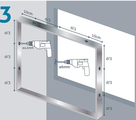
**COLOQUE EL MARCO:** Márquelo previamente y perfórelo utilizando broca de 4,5mm., según esquema. Para perforar el vano utilice broca de concreto de 6mm. El marco debe entrar libremente.
