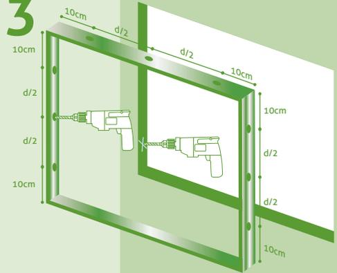
**COLOQUE EL MARCO:** Márquelo previamente y perforélo utilizando broca de 4,5mm, según esquema. Para perforar el vano utilice broca de concreto de 6mm. El marco debe entrar libremente.
